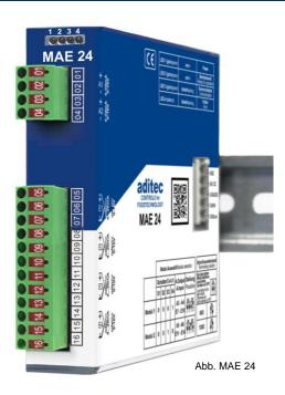
Das Gerät MAE 24 ist ein analoges Ein-/Ausgangsmodul mit insgesamt 6 Kanälen (4 Analogeingänge, 2 Analogausgänge). Zur Erweiterung in Kombination mit Steuerungen: MS 120, MS 220, MIC 900, MIC 1100, MIC 3000, MKA 500, MKA 800 einsetzbar. Über CAN-BUS-Anschluss erfolgt die Kommunikation mit den Basisgeräten. Die Programmierung des Moduls ist ebenfalls über CAN-BUS möglich. Das Modul ist für die Montage auf einer Hutschiene vorgesehen.
