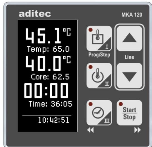
Über eine optionale Schnittstelle ist ein Datentransfer zwischen der Steuerung MKA120 und einem PC möglich. Die Steuerung ist über einen PC mit installiertem **aditec Serviceprogramm** programmierbar. Die Verbindung erfolgt über Mini-USB oder optional über LAN bzw. über Schnittstelle RS485.
