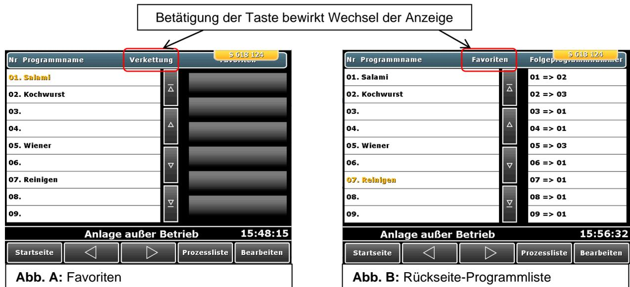
Durch Zuordnung der Nummern in der Rückseite-Programmliste (s. Abb. B) können Sie bestimmen, welches Programm in der Anlage „Rückseite“ gestartet werden soll, nachdem in der Anlage „Frontseite“ ein Programm beendet wurde.
